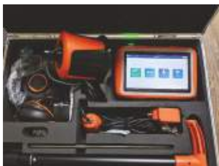
Geófono acústico para detección de fugas
